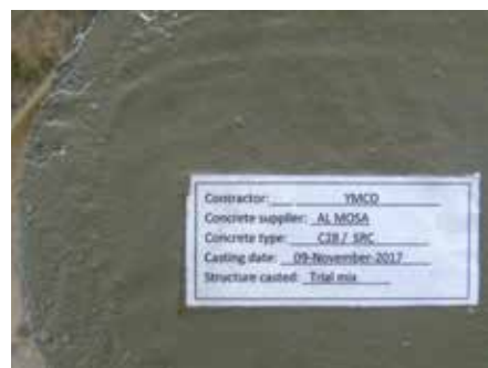
Εικ. 8Β: Λήψη δοκιμίων θλιπτικής αντοχής
