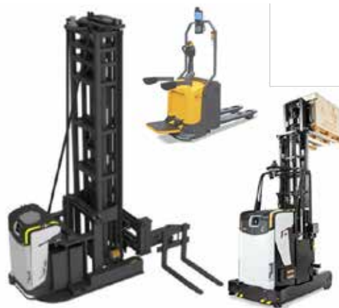
Εικ. 3 Τύποι Περονοφόρων AGV
